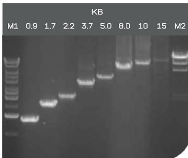
PCR Amplifikation unter Verwendung von EURx **Taq** DNA Polymerase. Spur M: Molekularer Größenmarker EURx Perfect™ 1-kb-Leiter (E3130-02). Spuren: 1.1 bis 9.3 kb: PCR-Amplifikation unter Verwendung von Puffer B mit 0.2 mM dNTPs und 1,25 U EURx **Taq** DNA Polymerase in einem Reaktionsvolumen von 50 µl.
